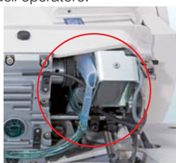
Meccanismo di inversione del trasporto a tasto
